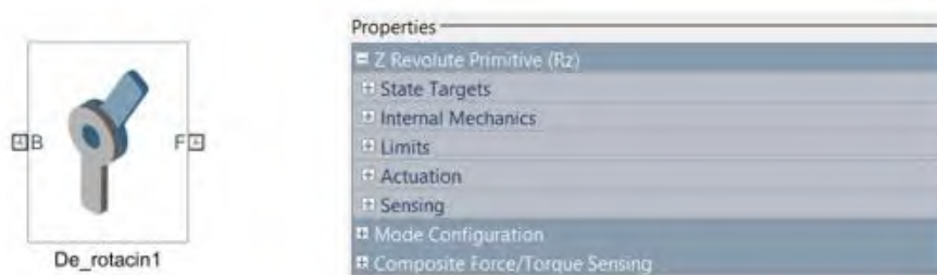
Figura 2.23. Bloque Joint y parámetros de la librería Simscape Multibody Fuente: elaboración propia
