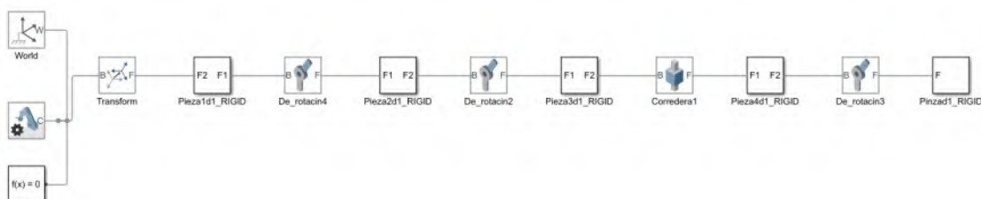
Figura 2.24. Ejemplo de importación de modelo 4GDL a Simscape Multibody Fuente: elaboración propia
